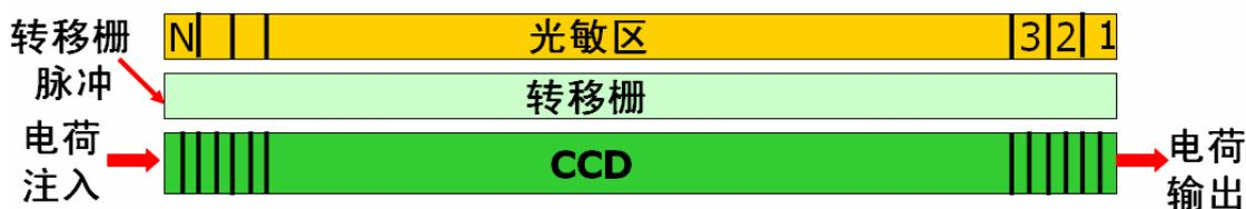
图 7.39 线阵 CCD 摄像器件的构成
